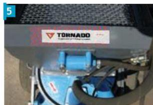
**5** Расположение вместительного загрузочного бункера на высоте менее 1 м значительно упрощает его заполнение как вручную, так и механическим способом.
