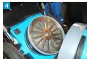
**4** Стоимость эксплуатации уменьшена на 30% благодаря конструкции с одной уплотнительной плитой. Возможность многократной шлифовки уплотнительной плиты и дозирующего барабана позволяет существенно снизить эксплуатационные расходы
