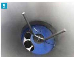
**Дополнительный миксер смеси** обеспечивает полное заполнение ячеек дозирующего барабана даже влажными смесями
