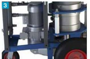
**Дисковый вариатор** позволяет плавно менять производительность в полном диапазоне, моментально адаптируя установку к необходимому виду работ
