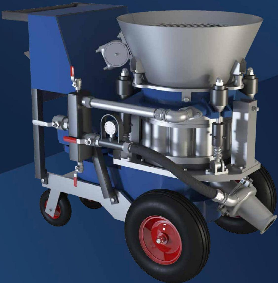
**Торкретирование** – метод укладки бетона (или материала с не цементным вяжущим), при котором смесь послойно наносится на поверхность под действием сжатого воздуха.
